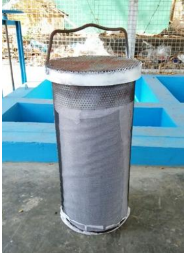
Filter dengan media ampas teh sebagai Adsorbent
